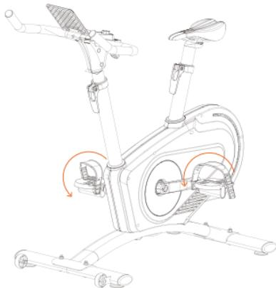
8.打开车把和车座下方的锁紧扳手,调节车把和车座至适合自己的高度,调节完成后重新锁紧扳手并充分紧固;注意此处请务必根据使用者身高调整完毕,以免发生危险或造成意外损伤。
